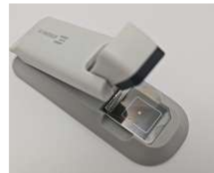
(4) 将检测卡放入压卡器的“卡槽”。
